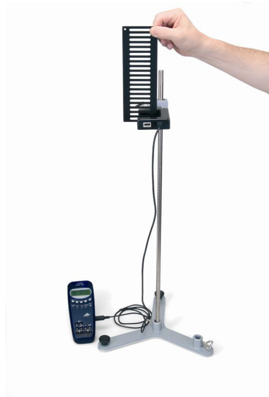
Fig. 2: Messung des Freien Falls
