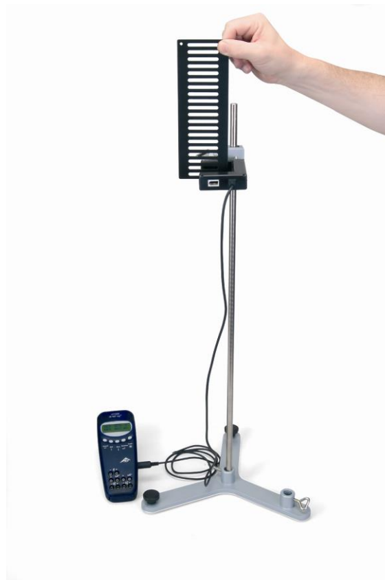
Fig. 2: Misurazione della caduta libera
