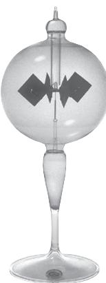
O radiômetro de Crookes serve para a demonstração da transformação de energia radiante em energia cinética.
