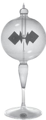
Das Radiometer nach Crookes dient zur Demonstration der Umwandlung von Strahlungsenergie in kinetische Energie.
