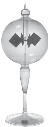
Le radiomètre de Crookes permet de démontrer la transformation de l'énergie de rayonnement en énergie cinétique.
