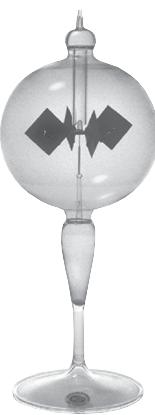
Il radiometro di Crookes serve per dimostrare la conversione dell'energia radiante in energia cinetica.
