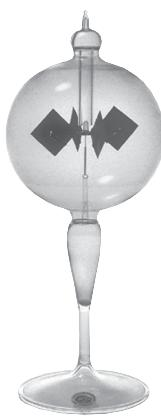
El radiómetro de Crookes se utiliza en la demostración de la transformación de energía de radiación en energía cinética.
