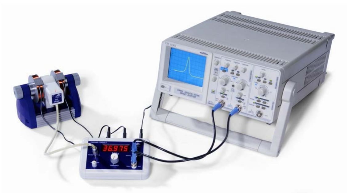
Fig. 5 Montagem experimental de ESR com um osciloscópio
