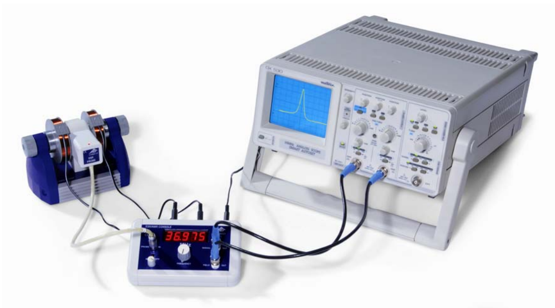
Fig. 5 Experimenteller Aufbau ESR mit einem Oszilloskop
