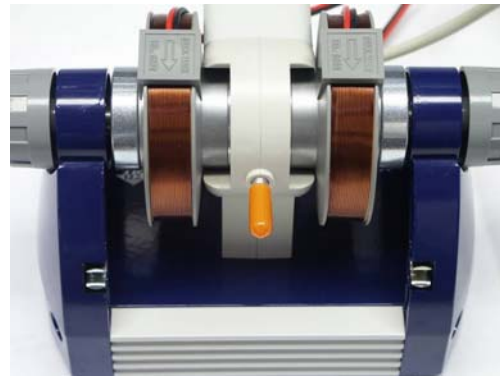
Fig. 4 Basiseinheit mit eingesteckter DPPH- Probe
