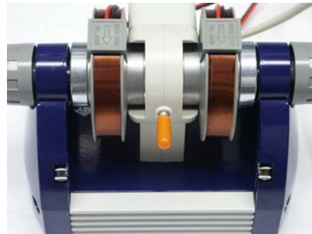
Fig. 4 Unità di base con campione DPPH inserito
