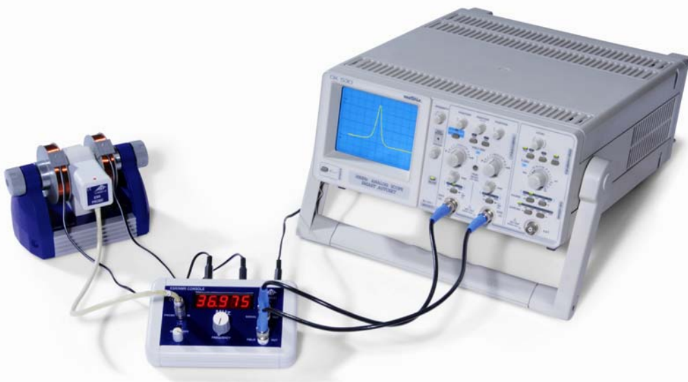
Fig. 5 Montaje experimental de REE con un osciloscopio
