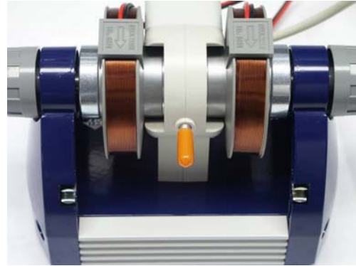
Fig. 4 Unité de base avec échantillon de DPPH
