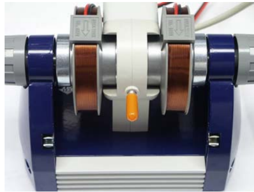
Fig. 4 Unidad básica con muestra de DPPH insertada
