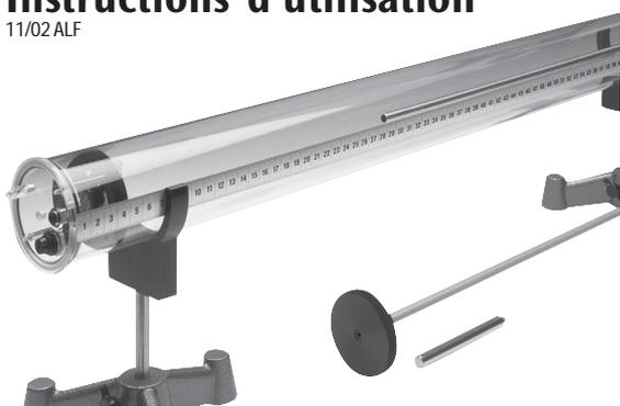
Le jeu d'appareils constitué du tube de Kundt et de ses accessoires permet d'illustrer les ondes acoustiques stationnaires avec des extrémités de tube ouvertes ou fermées ainsi que de déterminer la longueur d'onde dans l'air ou dans d'autres gaz.
