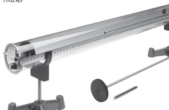
O conjunto de aparelhos tubos de Kundt e acessórios é utilizado na representação de ondas sonoras estacionárias com tubos fechados ou abertos, bem como para a determinação dos comprimentos das ondas no ar ou em outros gases.
