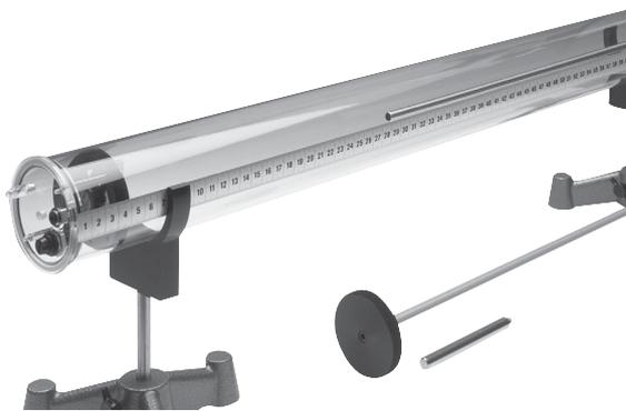
Der Gerätesatz Kundt'sche Röhre und Zubehör dient zur Darstellung stehender Schallwellen mit offenen oder geschlossenen Rohrenden sowie zur Bestimmung der Wellenlängen in Luft oder anderen Gasen.
