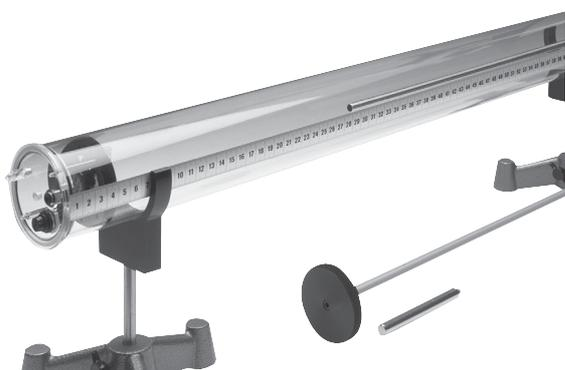
El equipo Tubo de Kundt y accesorios sirve para la representación de ondas sonoras estacionarias con los extremos del tubo abiertos o cerrados, así como para determinar longitudes de onda en el aire o en otros gases.
