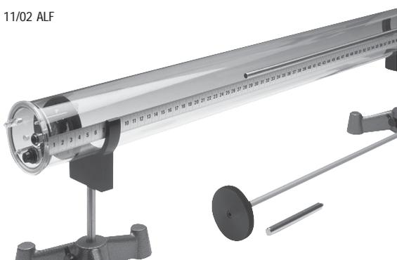
Il kit per il tubo di Kundt unitamente agli accessori serve per la dimostrazione delle onde sonore stazionarie con estremità aperte o chiuse del tubo, e per la determinazione delle lunghezze d'onda nell'aria o in altri gas.
