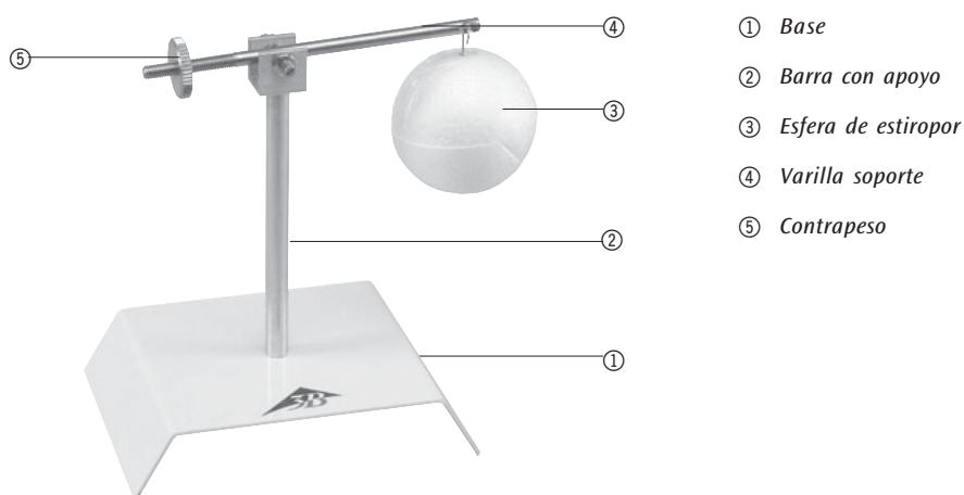
La balanza sirve para la comprobación del empuje ascensional de un cuerpo frente a la presión atmosférica.
